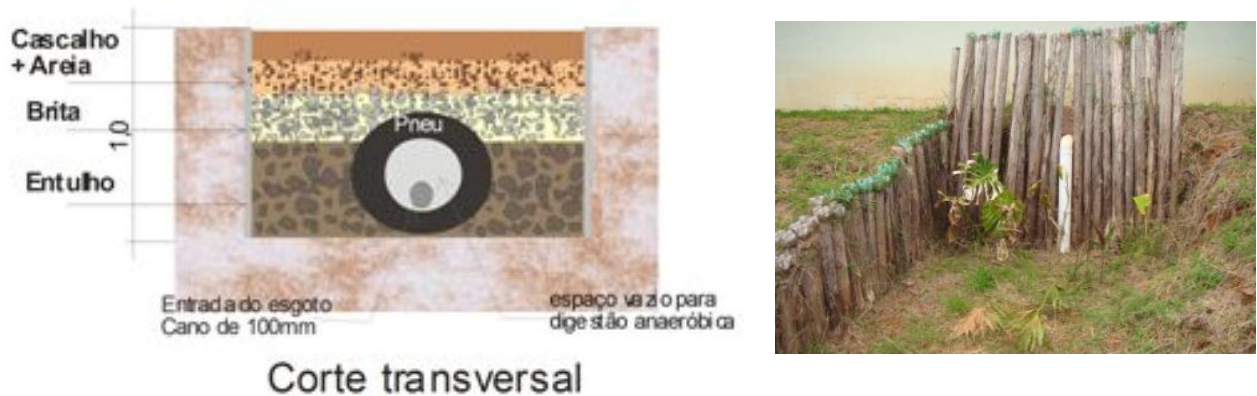
Figura-8 Dimensionamento e implantação da Fossa de Evapotranspiração. Fonte: EMATER-MG, Projeto técnico, 2010 e autora.
