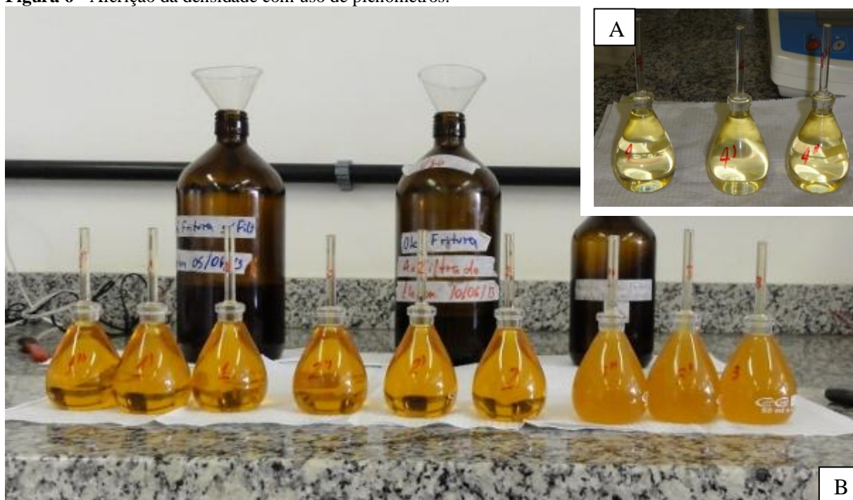
Figura 6 - Aferição da densidade com uso de picnômetros:
