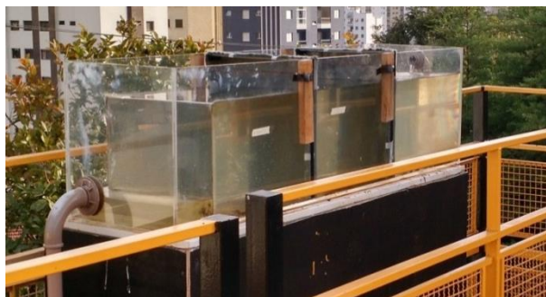
Figura 14- Canal utilizado no experimento com as barreiras instaladas.
