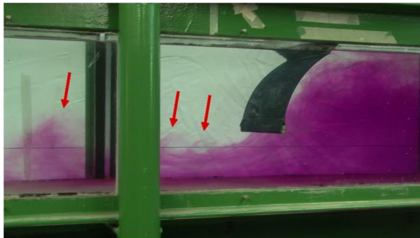
Figura 12 - Refluxo e turbulência gerada pela barreira suspensa
