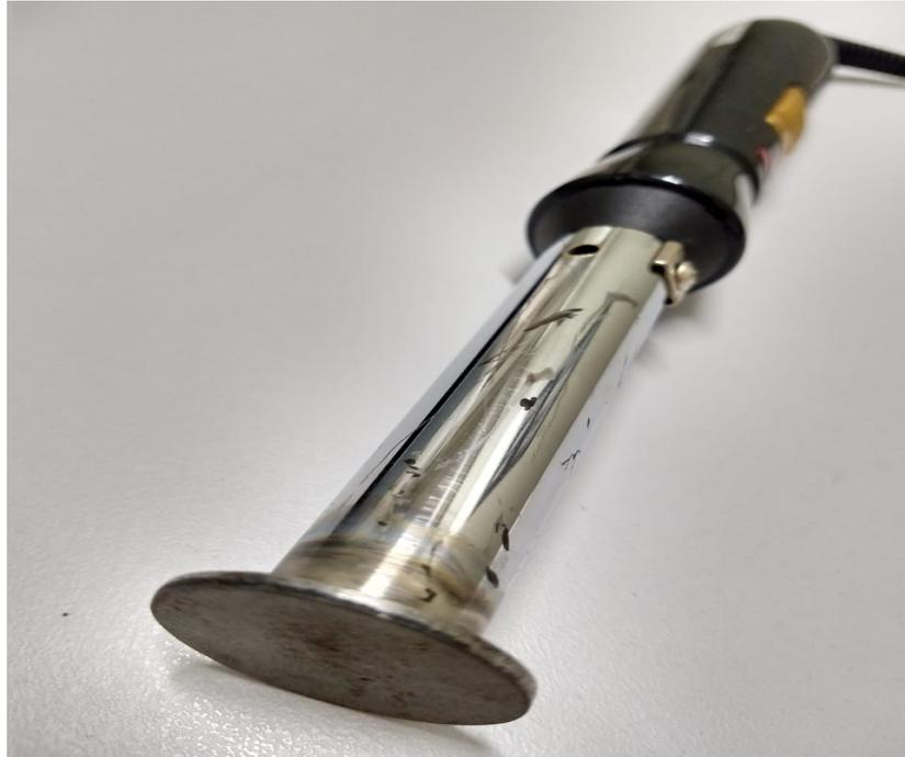
Figura 3 - Placa de ferro acoplada a resistência para gerar aquecimento
