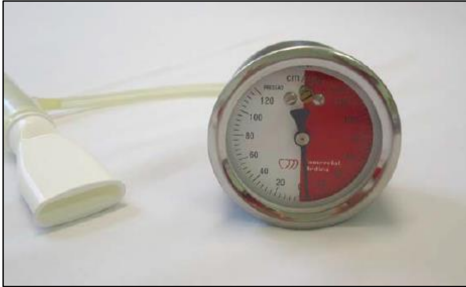
Figura 5 – Manovacuômetro analógico com bocal.
