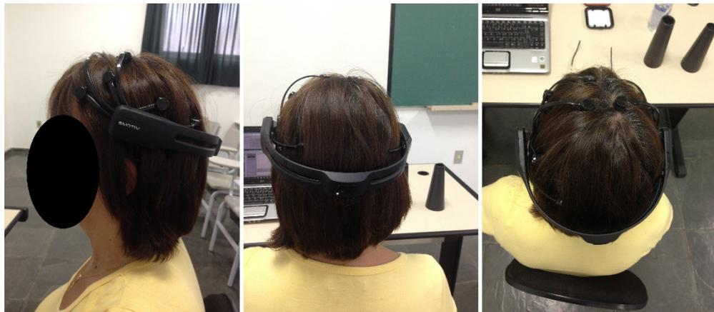
Figura 8 - Posicionamento do *Headset* para coleta dos dados
