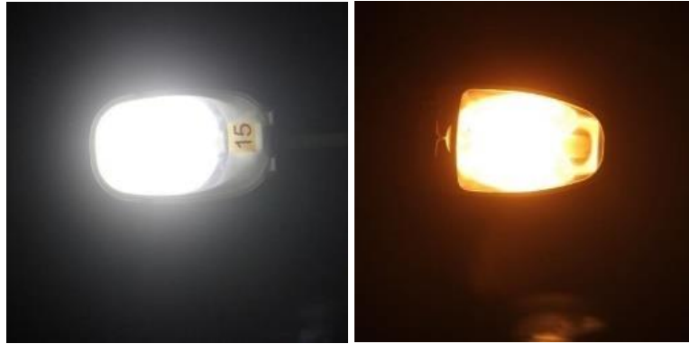
Figura 24 - Fotos de duas lâmpadas de 150W: MH (esquerda) e HPS (direita).
