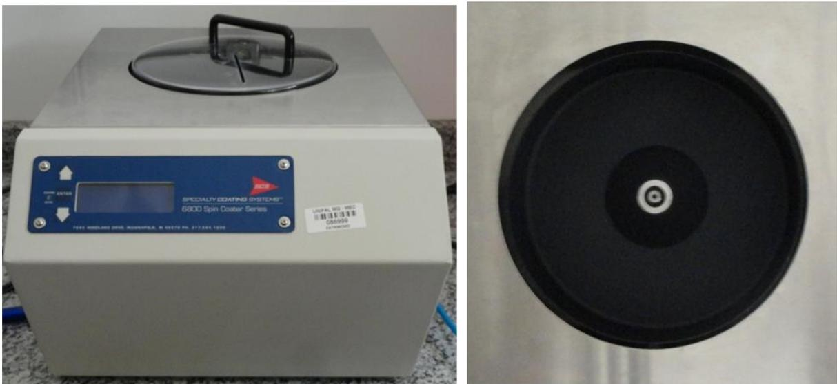
Figura 6 - Imagem do equipamento spin coating usado na deposição dos filmes. A esquerda o painel de controle, a direita vista da haste ou eixo que prende o substrato e executa o giro com aceleração, velocidade e tempos ajustados.
