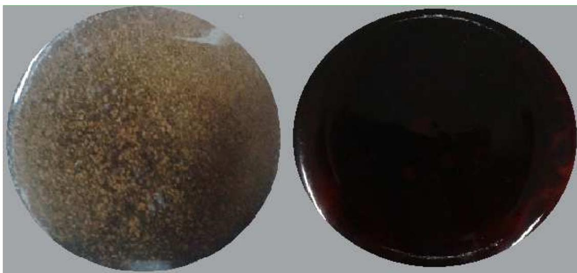
Figura 15 – A imagem da esquerda mostra o fundo do béquer na preparação da amostra  $Zn_{0,97}Mn_{0,03}O$  produzida pelo método Pechini sem modificação e a figura da direita mostra a imagem do fundo do béquer na preparação da amostra  $Zn_{0,97}Mn_{0,03}O$  produzida pelo método Pechini modificado.
