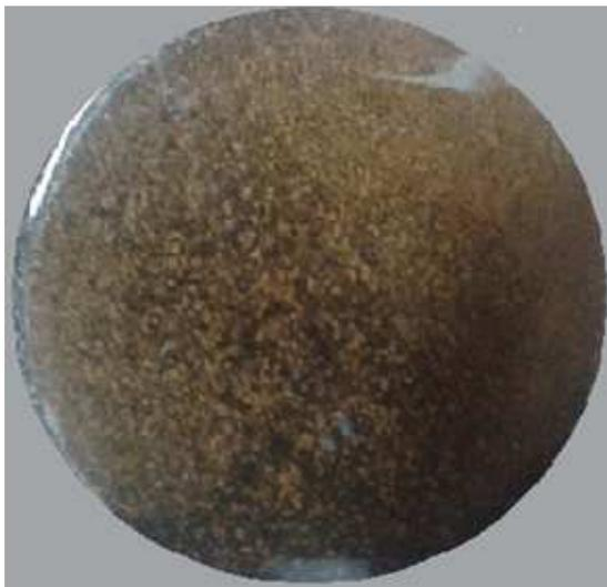
Figura 13 – Imagens do fundo do béquer durante a preparação da amostra  $Zn_{0,97}Mn_{0,03}O$  produzida pelo método Pechini. Os pontos brancos no fundo do béquer evidenciam a presença de precipitados na resina.
