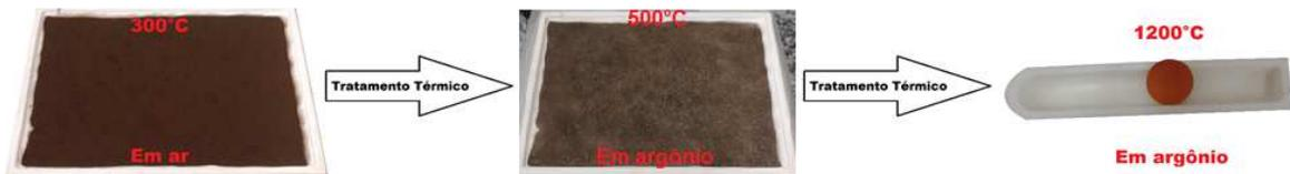
Figura 26 – Imagens ilustrando os aspectos para o do *puff* obtido com tratamento térmico da resina em 300°C em ar (a esquerda), para o tratamento térmico em 500°C em argônio (ao centro) e tratamento térmico da amostra na forma de pastilha entre 900 a 1200°C em atmosfera de argônio (a direita).
