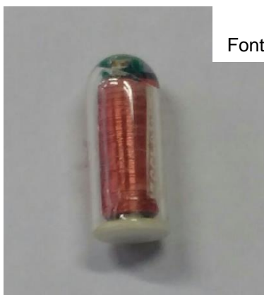
Figura 8 - Transmissor de temperatura (probe) / Demonstração do programa utilizado para coleta dos dados de temperatura, os quais são exibidos graficamente no monitor e armazenados em arquivo digital.
