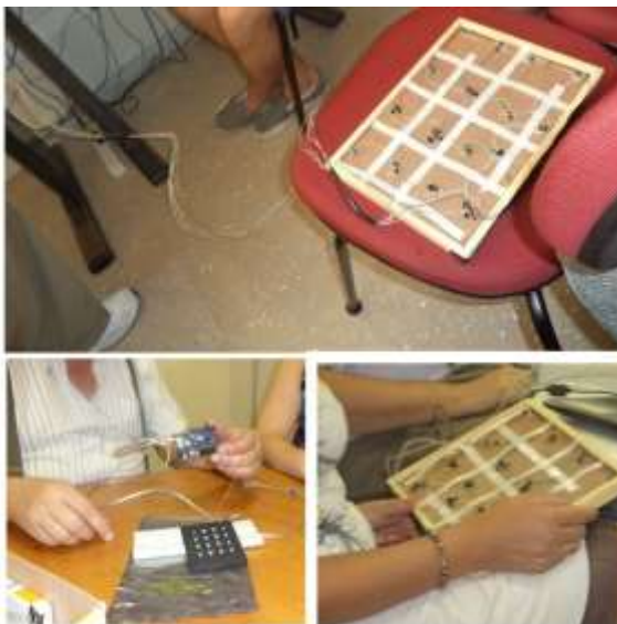
Figura 6: Conexão entre Arduíno, porta USB e trama de microchaves
