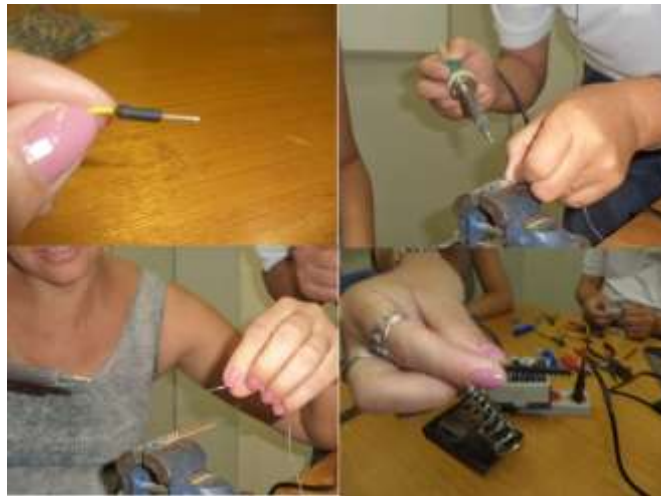
Figura 5: Montagem do Contact Adapter
