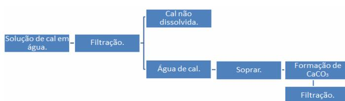
Figura 1: Fluxograma representando as etapas de filtração da água de cal
