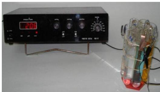
Figura 1: Sistema integrado de células galvânicas múltiplas, conectado a um potenciômetro.
